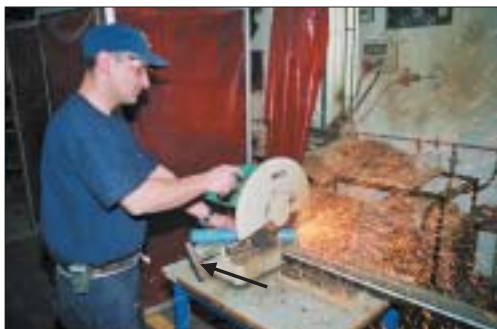
חיתוך צינור באמצעות אופן השחזה. הצינור מקובע במקומו במיתקן הידוק מתוצרת עצמית, כנדרש. ידית ההידוק ממוקמת באופן נוח להפעלה ומרוחקת מדיסקת החיתוך
