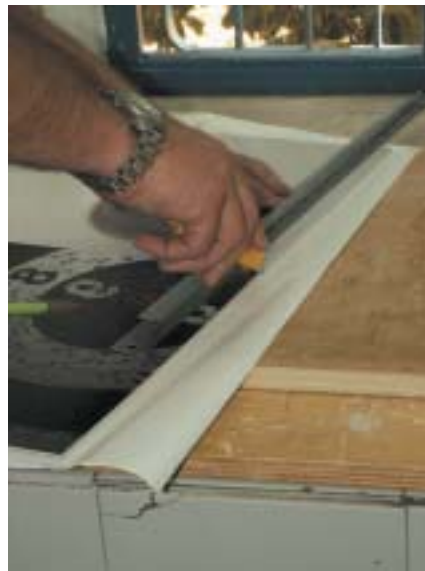
סרגל מתכת בטיחותי לחיתוך. לאורך הסרגל מוצמדת זווית מתכת המגינה על היד המהדקת את הסרגל לחומר הנחתך מפני להב הסכין המוחזקת ביד השנייה
