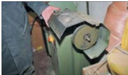
מיגון, תוצרת עצמית, מעל לאופן השחזה בסדנה לעיצוב תעשייתי, מונע מגע עם האופן והעפה של חלקים למרחק
