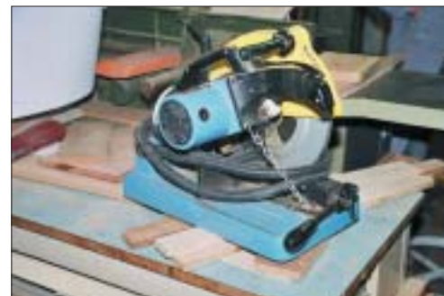
מסור עגול מיטלטל ("דיסק") בסדנה לעיצוב תעשייתי, נעול בשרשרת (רעיון מקומי), לפני העברתו בביטחה לאחסון
