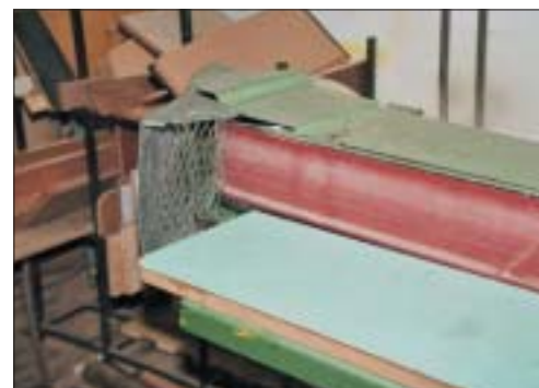
מכונת ליטוש עם סרט ליטוש אופקי. קצה הסרט מוגן ברשת מתכת המונעת כניסת חלקים לתוך החלק האחורי של המכונה, מבלי לפגוע ביעילות שאיבת האבק הנוצר במהלך הליטוש
