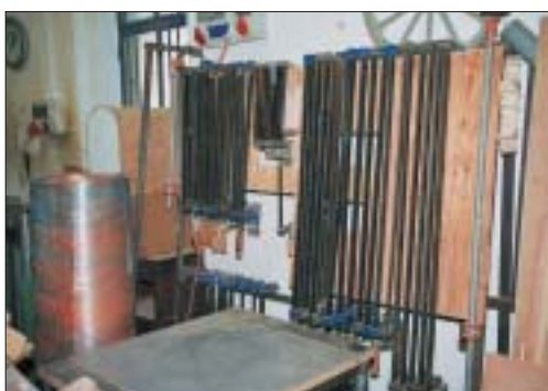
הכליבות (מלחציים) בסדנת העץ מאוחסנות באופן מרוכז על גבי מיתקן שימושי: לוח עץ אנכי בשיפוע קל לעבר הקיר מונע תנודות ונפילה של הציוד המתכתי
