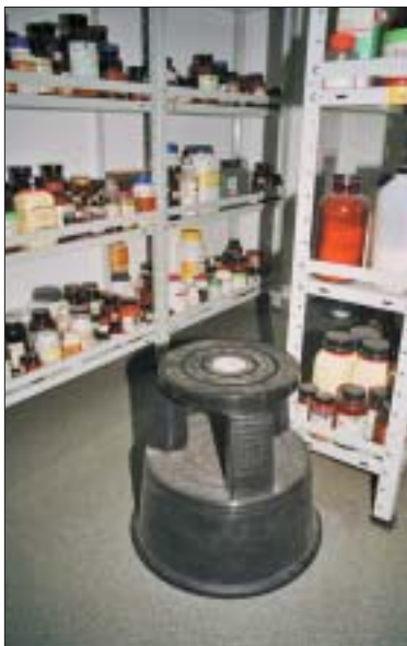
שרפרף במחסן הכימיקלים (קיים גם בספרייה), מצויד בגלגלים. כאשר עומדים על השרפרף משקל הגוף, המצמיד את שולי השרפרף לרצפה, מונע את תנועת הגלגלים. בחזית המדפים מותקנים פסי הגנה למניעת נפילה של בקבוקים
