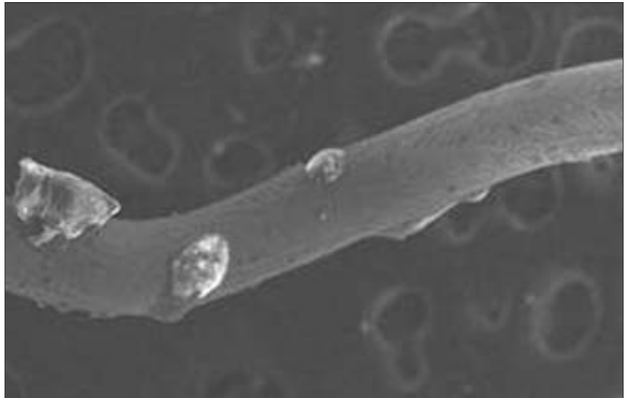
חוט להט של נורת רכב בהגדלה של מיקרוסקופ אלקטרוני סורק. על החוט נראים שברי אגס הזכוכית ששקעו בחוט הלהט ברגע ההתרסקות.
