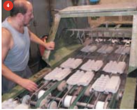
4. האזור המהווה סיכון לידי העובד ממוקם במרחק המבטיח שידי העובד לא יגיעו אליו
