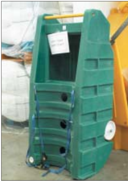
◀ מאצרה ניידת עבור חביות. החיבור לחבית מתבצע כשהיא זקופה
