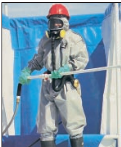
בגד מגן "נושם" להגנה מפני נוזלים וחלקיקים מיתקן לשטיפת הבגד, מונע זיהום הסביבה
