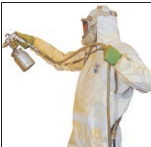
בגד מגן "נושם" להגנה מפני נוזלים וחלקיקים מיתקן לשטיפת הבגד, מונע זיהום הסביבה
