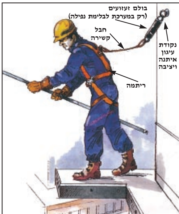
דוגמה של אבטחת עובד בגובה, באמצעות מערכת לבלימת נפילה הכוללת ריתמת בטיחות
