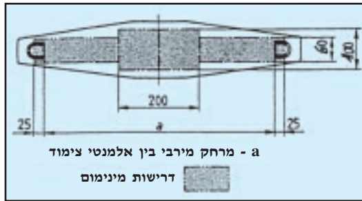
תומך גב של מערכת מיקום בעבודה - דוגמה למידות מינימליות (המידות במ"מ) (מתוך ת"י 1849)
