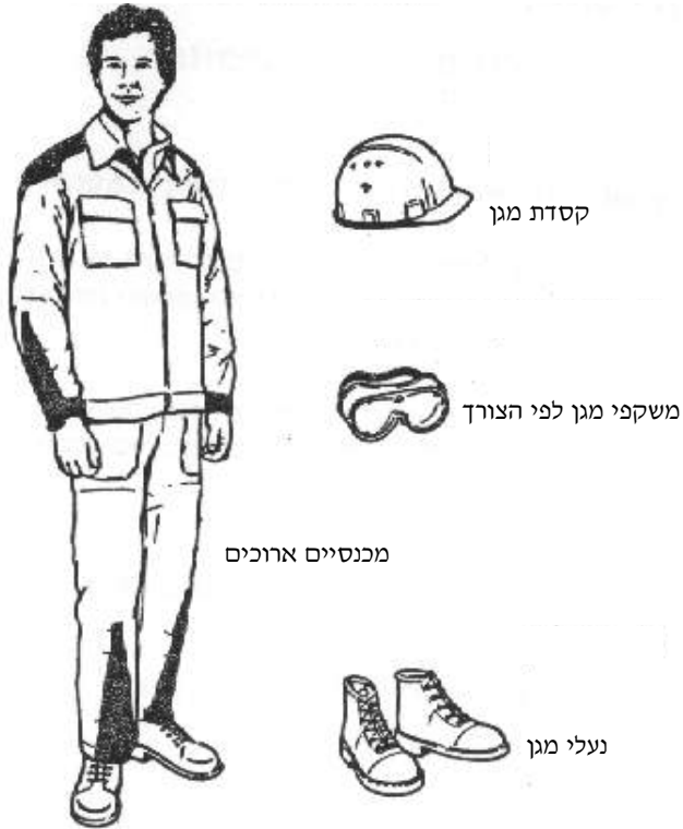
ציוד המגן האישי הנדרש, עפ"י החוק וכללי המקצוע, לעבודות החשמל במתח נמוך
