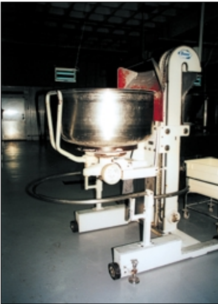
מיתקן להרמה ולהסעה של סיר המלוש. קשת הפלדה המותקנת בחלקו התחתון מונעת כניסת עובד לאזור המיכל בזמן ירידתו
