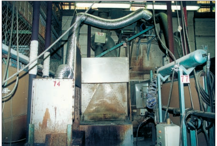
מערכת יניקה מקומית, לנידוף אדים מעמדות ההלחמה בטבילה ומעמדות הייבוש
