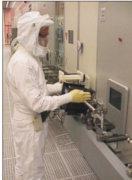
טעינת מנת פרוסות למכונת ייצור בתנחות גוף נייטרלית - המנה נישאת בגובה המרפקים, באופן סימטרי לגוף וקרוב למרכז הכובד שלו
