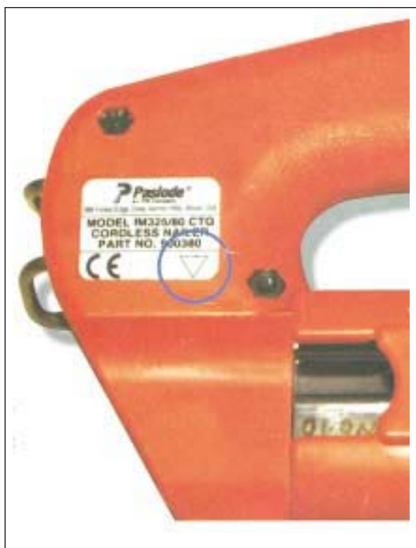
לוחית עבור מכשירי הצמדה בעלי הדק שחרור וניצרה שאינם תלויים האחד בשני (הסימון: משולש שווה צלעות העומד על קודקודו - מסומן בעיגול) ועם סימון השוק המשותף - CE
