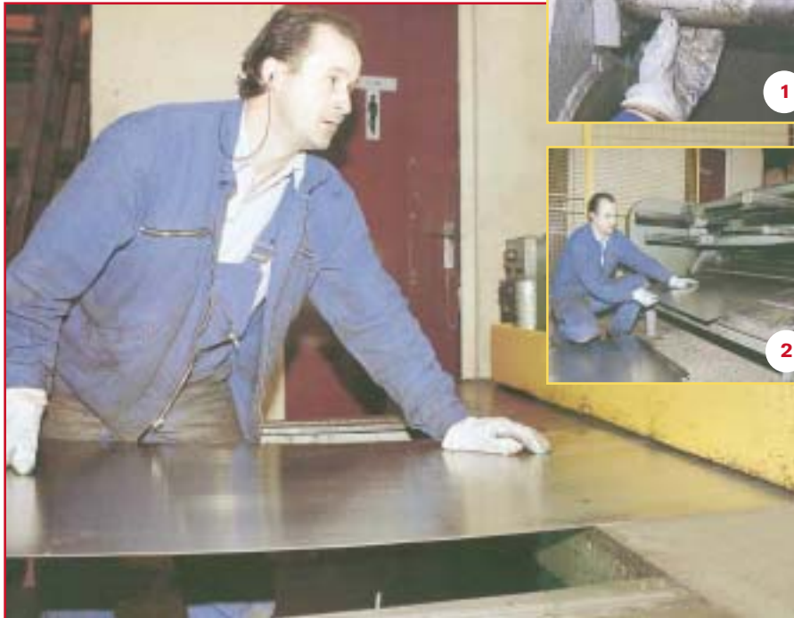
המפעיל הקבוע ליד הגיליוטינה לחיתוך פח מכניס לתוכה לוח פלדה לגזירה 1. גליל תמיכה והובלה מסתובב חופשי על התומך שלו 2. הלוחות הגזורים הגדולים נשמטים גבי גליל לקליטה ולהסעה
