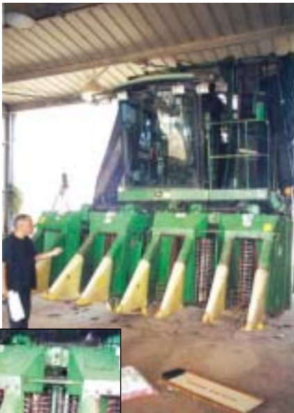
למעלה - חזית קטפת כותנה עם 4 "תופי קטיף" הכוללים אצבעות מסתובבות לתלישת הצמחים והפרדת הסיבים מהפקעות. משמאל - תוף קטיף (פרט)
