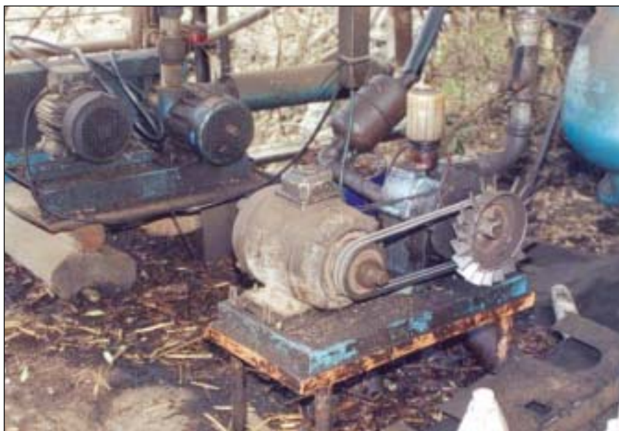
אין מיגון על מערכת ההנעה של משאבת הוואקום הרזרבית (המשאבה הראשית ממוגנת)
