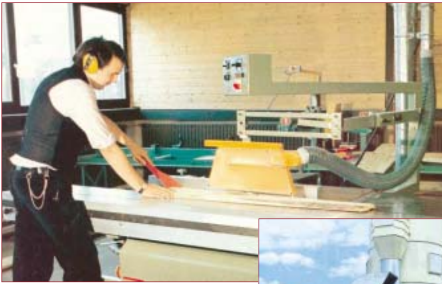
מערכת שאיבה מרכזית. למעלה: צנרת איסוף מותקנת על פתחי שאיבה במכונה. מימין: "ציקלון" שאליו מועבר האבק באמצעות תעלות האיסוף
