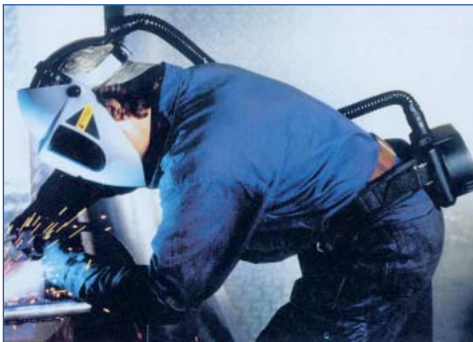
עובד מוגן במסיכת נשימה בעלת משאבה (מותקנת על החגורה, מאחור) לאספקת אוויר מסונן
