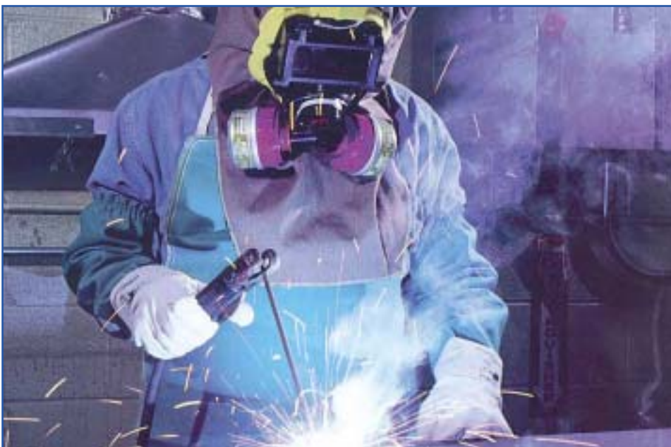
עובד מרתך מוגן היטב בציוד אישי: ברדס ומסיכת ריתוך הכוללת לוח סינון ומסננים, סינר עבה וכפפות עבודה יבשות ונקיות
