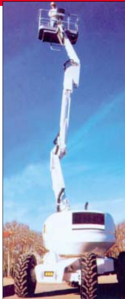
תא לעבודה בגובה על גבי מיתקן ממונע, נייד (דוגמה)
