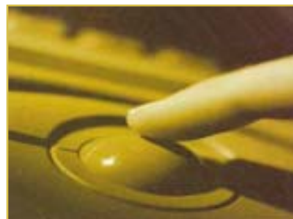
כדור העקיבה הוא התקן להזנת נתונים למערכת המחשב בהצבעה על אובייקטים גרפיים שעל הצג, באמצעות גלגול כדור המותקן בתוך תושבת
