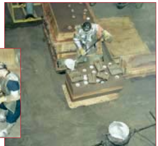
עובד יוצק אלומיניום מותך מתוך כף יציקה לתוך דפוס יציקה, להשלמת מילוי מערכת הכניסות וההזנה
