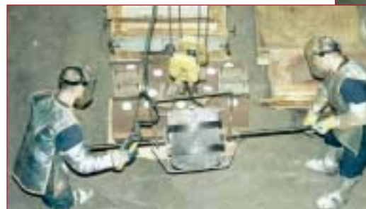
עבודת צוות ביציקת אלומיניום מותך מסיר יציקה לתוך דפוס חול. העובדים מוגנים בביגוד מגן להגנה מפני שפך של המתכת הלוהטת
