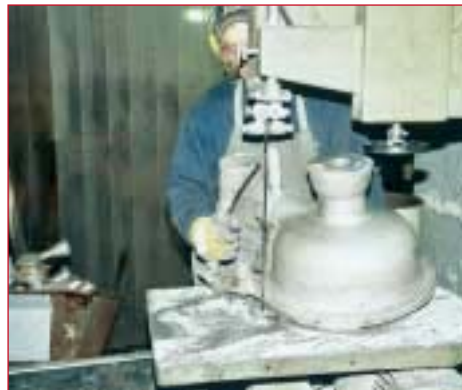
שימוש במסור סרט לניסור עודפי האלומיניום מהמוצר לאחר הוצאתו מתבנית היציקה
