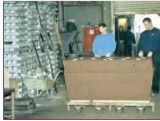
שינוע דפוס יציקה לאחר הרכבתו ע"ג מישטחים בגודל המתאים, בעזרת 2 עגלות מישטחים
