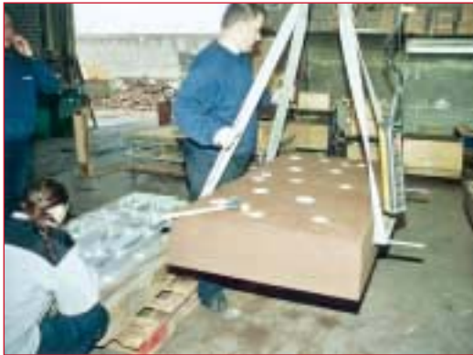
חליצת חצי דפוס חול עליון כבד (בד"כ כ-300 ק"ג) ממודל, לצורך הוצאת המודל ולפני סגירת חצי הדפוס התחתון לקראת יציקה חדשה
