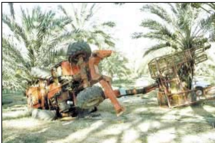
"מניסקופ" לאחר ההתהפכות. באזור במת העבודה ניתן לראות את מיכל המים (הצהוב) הגדול שהותקן עליה
