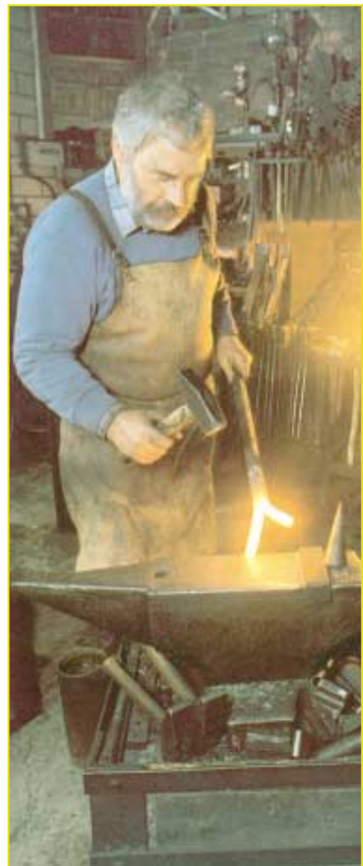
נפח מחשל מוט פלדה באמצעות פטיש נפחים רגיל על סדן סטנדרטי, אך ללא אמצעי ההגנה הנדרשים
