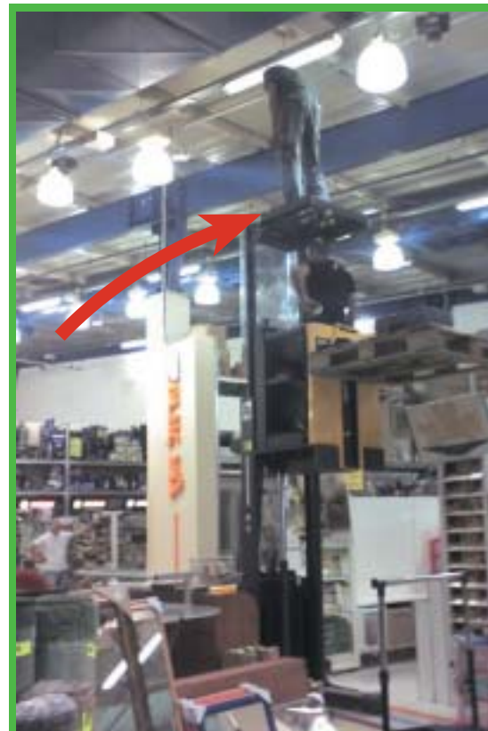
הורם לגובה התקרה על גבי מישטח אריזה שהורכב על מזלגות מלגזה
