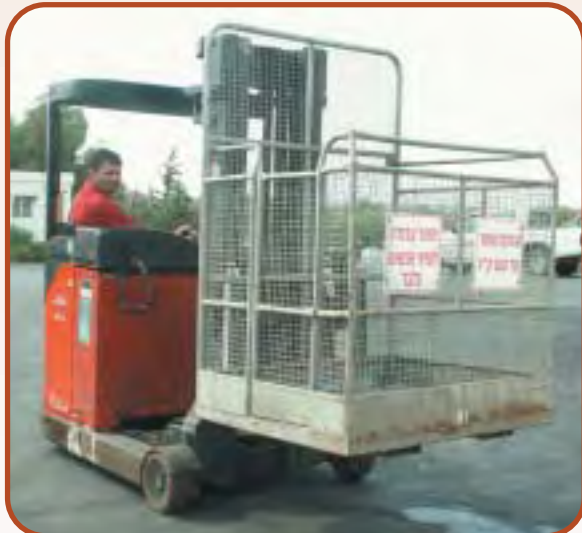
מלגזה חשמלית עם תא להרמת אדם. התא מוצמד לתורן על ידי זרועות מיוחדות. דלת התא (נפתחת החוצה) מוחזקת סגורה תמיד בעזרת קפיץ ואפשר גם לנעול אותה באמצעות בריח
