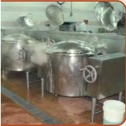
עמדת בישול בסירי קיטור תעשייתיים. שבכה מכסה נוזלים הנשפכים לרצפה במהלך העבודה
