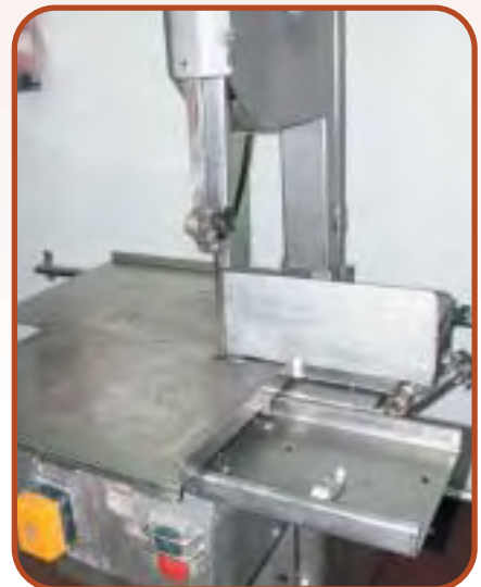
מסור לחיתוך בשר. קיים מוביל ייעודי להנעת הבשר הקפוא אל להב המסור ומיגון באזור הגלוי של סרט הניסור
