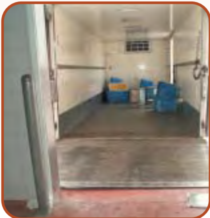
תא העמסה של משאית קירור עם כבש מתכוונן לגובה הרמפה ופסי קשירת עגלות לאבטחה בשעת נסיעה
