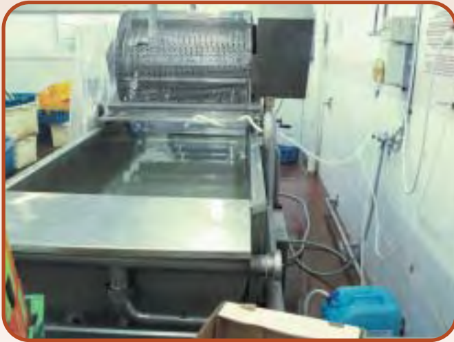
מיתקן לחיטוי ירקות. מיכל חומר החיטוי (כחול) מזין את המכונה באמצעות משאבת מינון למניעת שפיכה ומגע אקראי (בעבר הוצב מיכל חומר החיטוי על המכונה והנוזל זרם בכוח הכבידה)
