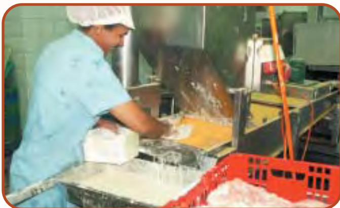
מכונת טיגון תעשייתית (מנהרה). קיים מיגון מעל לתחילת רצועת השינוע
