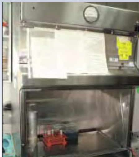
מינדף לעבודה עם גורמי סיכון ביולוגיים. שימו לב לשעון הלחץ שמעל לחלון המינדף (לבקרת מסנן ה-HEPA) ולשיפוע החלון פנימה
