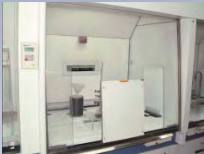
המינדף כולל חזית שקופה - קבועה באלכסון כלפי פנים (לנוחיות - אפשרות לקרב את הפנים לחלל המינדף); מגן עופרת, להגנה על גוף העובד מפני קרינה ופתחים להכנסת הזרועות לתוך חלל המינדף, כשהגוף נשאר מחוץ לתחום העבודה
