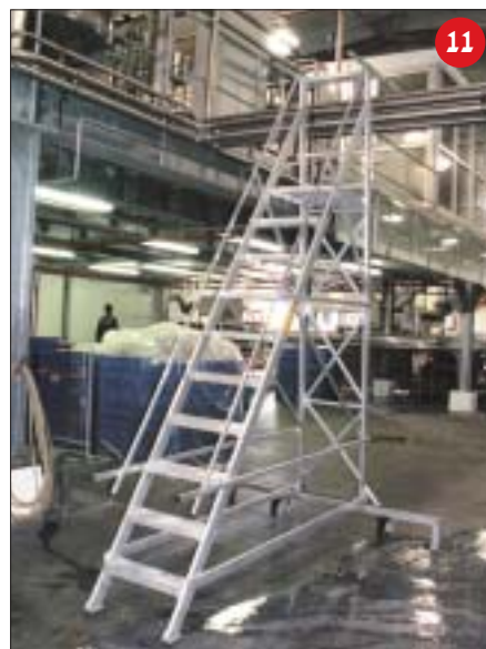
סולם נייד הכולל קורה לייצוב בסיס הסולם ומעקות אחיזה עליונה בטוחה על הסולם
