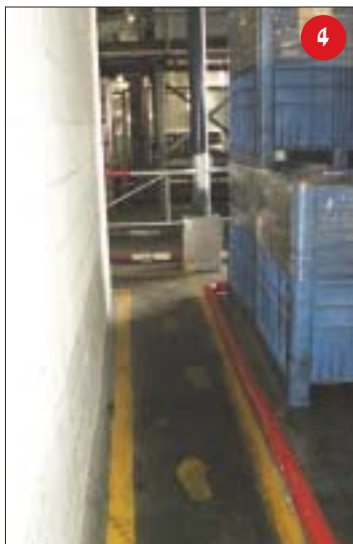
מעבר חופשי להולכי רגל מתאפשר הודות לתיחום אזור אחסנת מיכלי 'דולב' באמצעות צנרת המקובעת מעל למיפסל הרצפה
