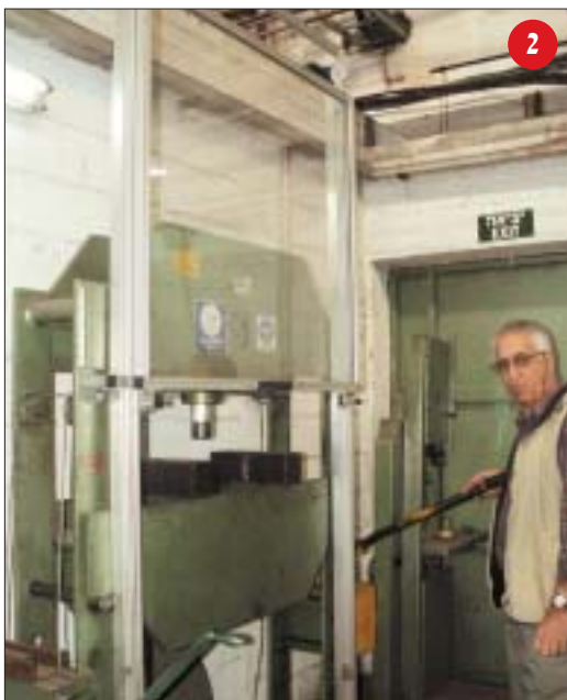
ידיעות ההפעלה של המכש הלוחץ ההידראולי. מימין: ידית הפעלת הלחיצה. משמאל: ידית מנואלה לקביעת גובה השכב
