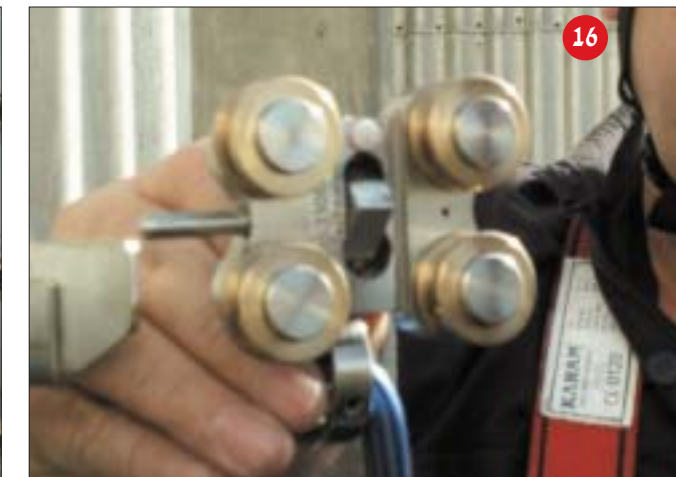
מראה של "עגלת ההחלקה" מצד הפס עם קצה המנוף - המתחכך ובולם החלקה לא מבוקרת
