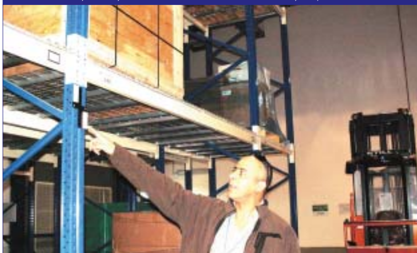
תמונה 10: חיישן פיקוד להפחתת מהירות המלגוזה עם התקרבה לקצה השדרה
