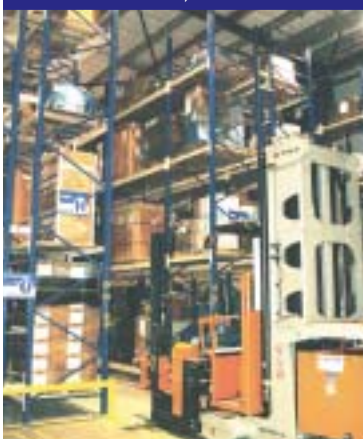
תמונה 9: המלגזה נכנסת אל בין שדרות מדפי האחסון. הנהיגה בין השדרות בשליטת קווים תת-רצפתיים
