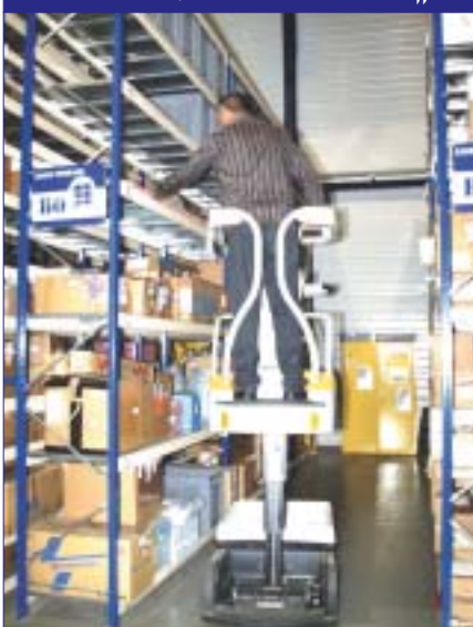
תמונה 16: מאספת משלוחים בפעולה. התא מוקף בגידור מתאים למניעת נפילה מגובה
