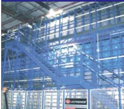
תמונה 8: מערכת מדרגות וגידור לעלייה אל חלקים גבוהים של המחסן האוטומטי
