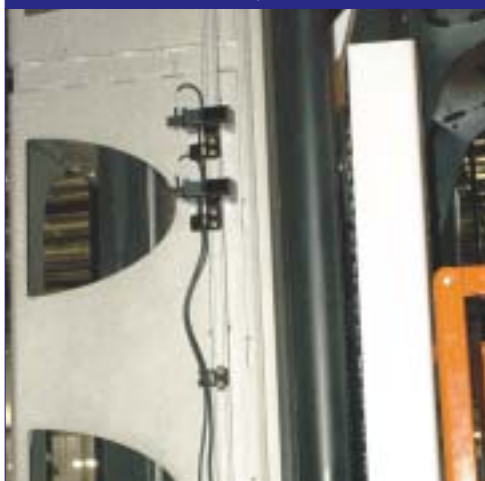
תמונה 11: חיישן קליטת הפיקוד להפחתת המהירות על גבי המלגוזה
