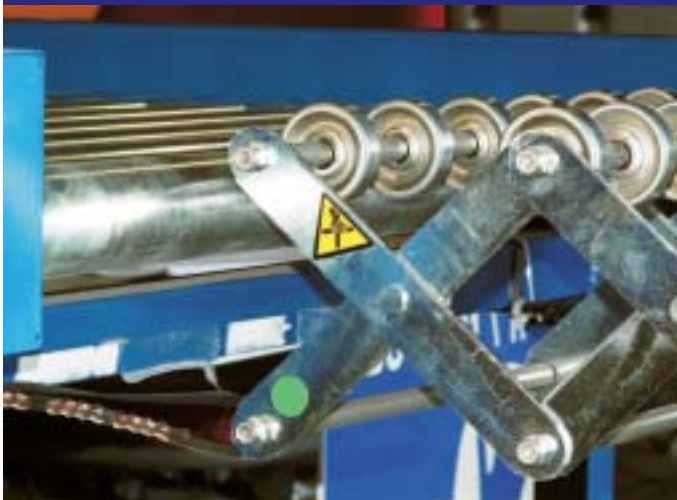
תמונה 4: המסועים הגרביטציוניים בנויים כהרמוניקה המערכת המתכווננת כוללת זרועות היוצרות סיכון לצביטה
