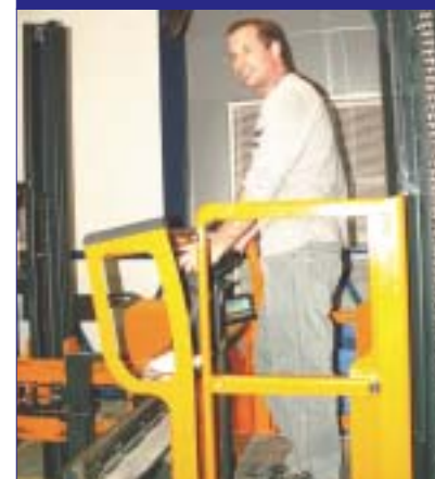
תמונה 12: מפעיל המלגוזה נמצא בתוך מרחב מוגן וחייב לנהוג כששתי ידיו על ידיות מערכת ההיגוי
