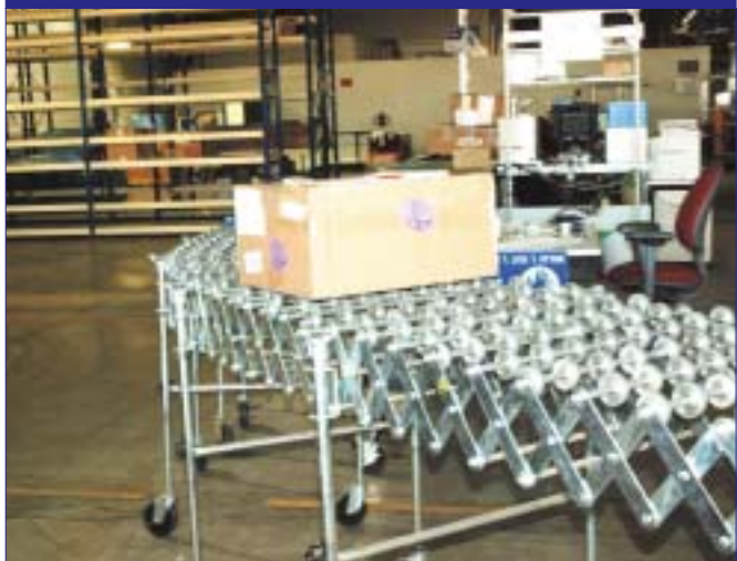
תמונה 5: תנועת האריזה על גלילי הסעת האריזות מתמרזות תמיד
