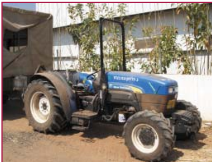
טרקטור של המשק, מצויד במסגרת בטיחות להגנת הנהג למקרה התהפכות
