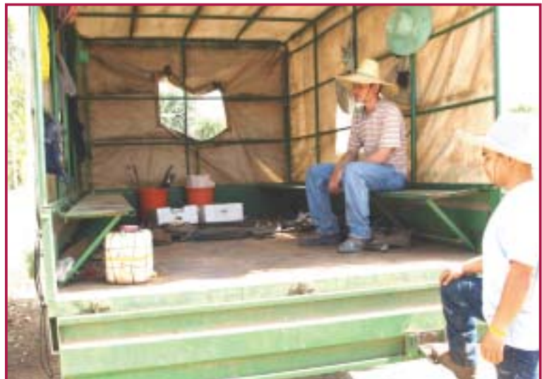
עגלה רב שימושית - לשינוע תוצרת ולהסעת עובדים. מדרגה על הדופן האחורית של מאפשרת עלייה נוחה אל מישטח העגלה
