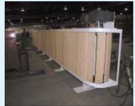
מסוע סרט מסוג "שלבים" בתהליכי ייצור, לפני הנחתו והרכבתו
