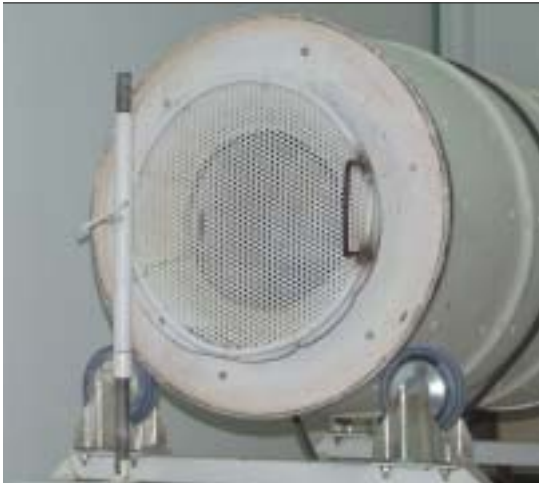
▲ תמונה 8: מערבול למיצוי האבקה עם דלת מרוששת שמפחיתה תפוצת אבקה לסביבה
