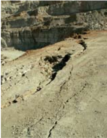
תמונה 8: סדקים בסלע, בשפת הטרסה, לאחר הפיצוץ
