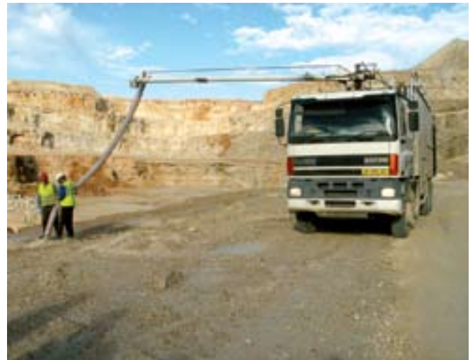
תמונה 5א': המיכלית, ממנה מזרזם באמצעות צינור חומר נפץ אל הקדחים
