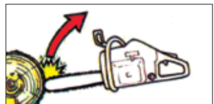
איור 2: מצב רתיעה לאחור של מסור שרשרת בעל גוף מסור סימטרי: לא בטיחותי
