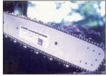
תמונה 2: קדחי קירור באזור החרטום משפרים את עמידות הגוף
