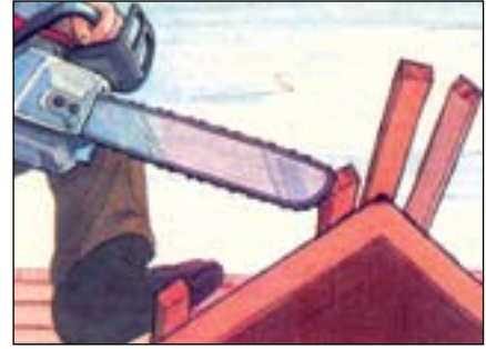
איור 3: גוף מסור לא סימטרי מאפשר למנוע רתיעה לאחור במהלך הניסור. בטיחותי
