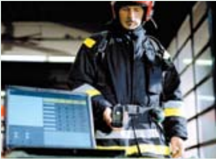
ביד הכבאי מוצגת מערכת שידור נתונים לעמדת הפיקוד. במהלך הפעולה היא נמצאת בתוך חליפת המגן
