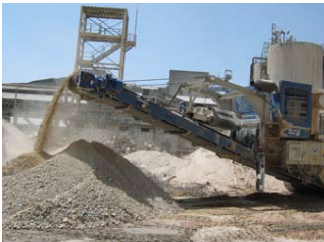
גריסת חומרי הבטון ועירוםם לצורך שינוע לכיבשני המפעל למיחזור
