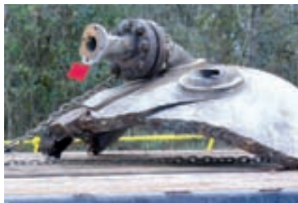
כיפת הריאקטור העשויה מפלדה בעובי 7.5 ס"מ, עפה למרחק של כ-150 מ', כשהיא פוגעת במהלך מעופה במיכלית שעמדה בסמוך למיתקן
