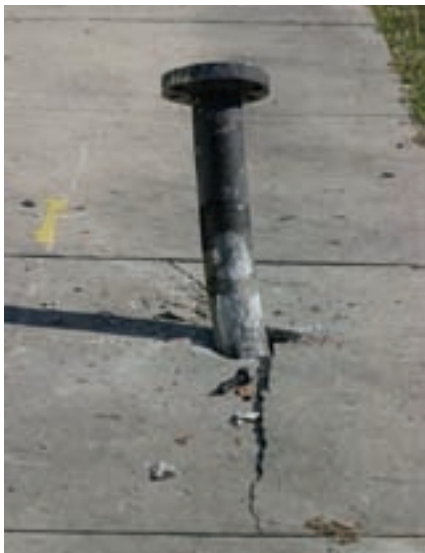
ציר הבוחש שנכנס לתוך המדרכה במרחק של כ-130 מ' מהריאקטור כתוצאה מהפיצוץ
