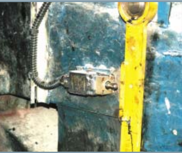
תמונה 6: הבטחת המגע בין זרוע מוט המיגון למפסק באמצעות הרחבה ע"י לוחית ("פלטקה") מתכת
