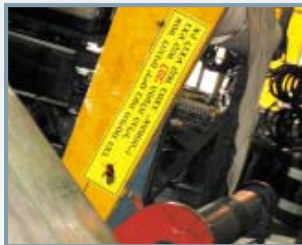
תמונות 7, 8, 9: שילוט על גבי מכונות ערגול לאזהרה מפני הסיכונים
