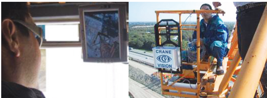
תמונה 1: מערכת ראייה קריין ויז'ין - יחידה חיצונית ויחידה פנימית
