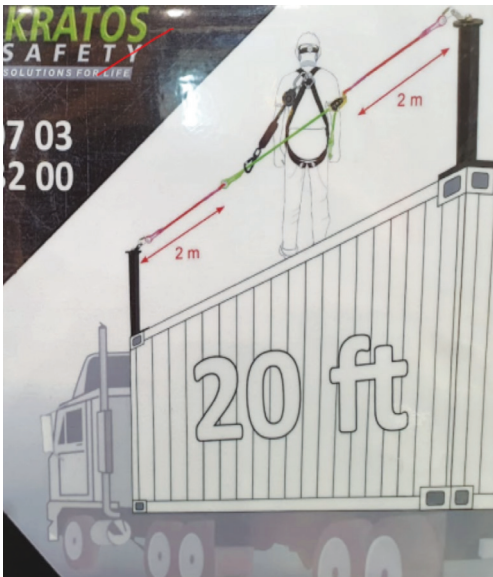
מערכת, הכוללת קו חיים, לעבודה על מכולה
