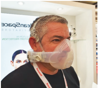
מסכת נשימה עם פילטר, המופעל על ידי סוללות מאחור, כולל מערכת התראה להחלפת מסנן
