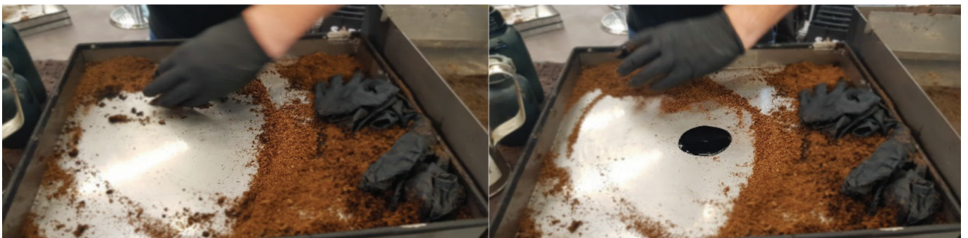
כתם שמן, שמתנקה באמצעות פיזור פתיתי חומר ספיחה, הלוכד שמנים ומותיר את הרצפה יבשה
