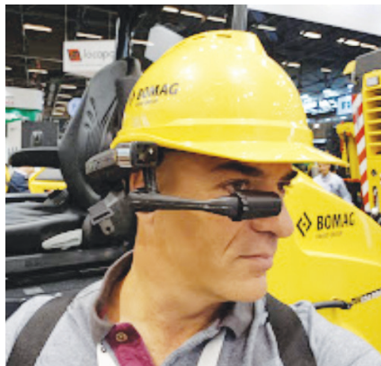
מערכת להעברת מידע לעובד על גבי קסדת מגן
