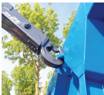
וו הרמה עם לשונית נעולה לקראת הרמה וו הרמה עם לשונית פתוחה לקראת שחרור המכולה וו הרמה עם לשונית פתוחה ומשתחרר מהמכולה וו הרמה עם לשונית פתוחה ומשתחרר מהמכולה וו הרמה עם לשונית פתוחה ומשתחרר מהמכולה
