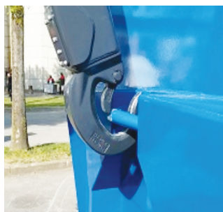
וו הרמה עם לשונית נעולה לקראת הרמה וו הרמה עם לשונית פתוחה לקראת שחרור המכולה וו הרמה עם לשונית פתוחה ומשתחרר מהמכולה וו הרמה עם לשונית פתוחה ומשתחרר מהמכולה וו הרמה עם לשונית פתוחה ומשתחרר מהמכולה
