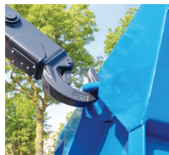
וו הרמה עם לשונית נעולה לקראת הרמה וו הרמה עם לשונית פתוחה לקראת שחרור המכולה וו הרמה עם לשונית פתוחה ומשתחרר מהמכולה וו הרמה עם לשונית פתוחה ומשתחרר מהמכולה וו הרמה עם לשונית פתוחה ומשתחרר מהמכולה
