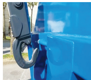
וו הרמה עם לשונית נעולה לקראת הרמה וו הרמה עם לשונית פתוחה לקראת שחרור המכולה וו הרמה עם לשונית פתוחה ומשתחרר מהמכולה וו הרמה עם לשונית פתוחה ומשתחרר מהמכולה וו הרמה עם לשונית פתוחה ומשתחרר מהמכולה
