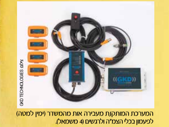
המערכת המותקנת מעבירה אות מהמסדר (ימין למטה) לפעמון בכל הצמ"ה ולרשמים (4 משמאל).
