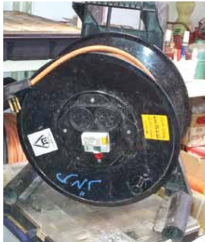
תמונה 2: תוף כבל מאריך ביתי ומשרדי, עם מפסק מגן. בתמונה חסר סימון על גבי התוף המחויב על פי התקן לגבי שימוש במימסר פחת
