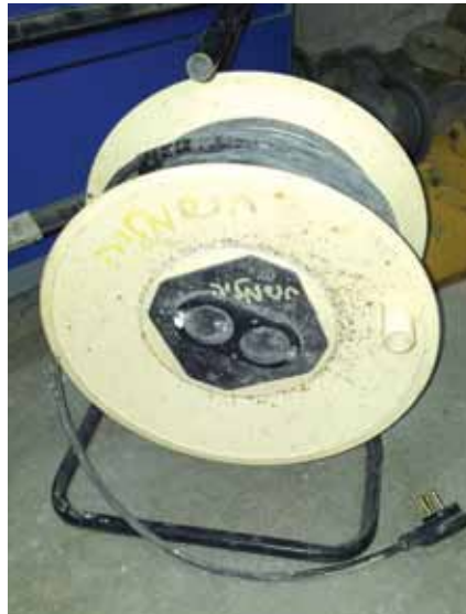
תמונה 1: תוף כבל מאריך (פנדל) המיועד לשימוש ביתי, משרדי וכדומה. בתמונה חסר סימון על גבי התוף כמתחייב מהתקן
