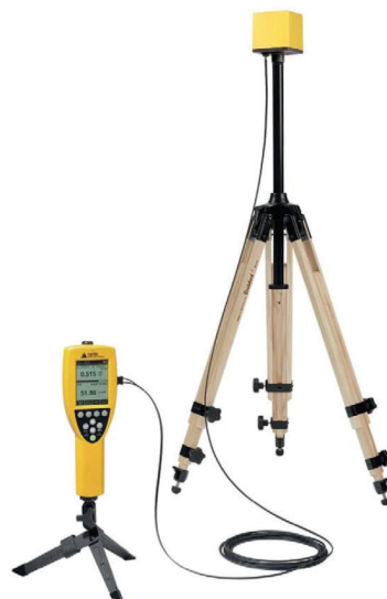
הרגש מחובר למד קרינה באמצעות סיב אופטי ומותקן על חצובה ייעודית מעץ (בעלת השפעה נמוכה על השדות)
