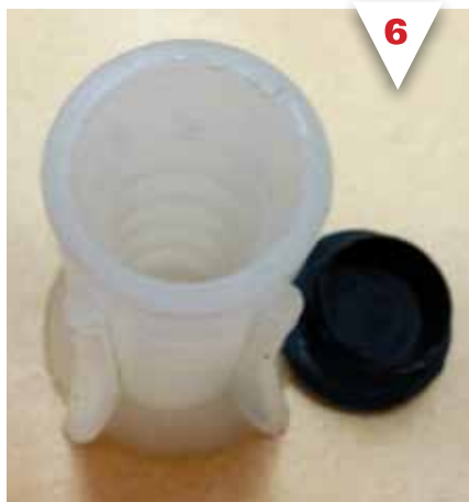
תמונה 6: הבקבוקון והפקק באמצעותו ניתן לחבר רגל מסגרת לרצפת הבטון
