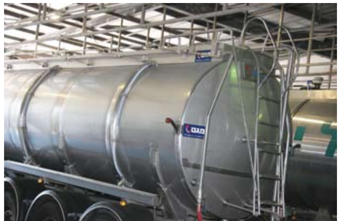
המכליות מגיעות לעמדת הפריקה. בעזרת הסולם הקבוע העובד, שקיבל הדרכה, מטפס. לאורך גב המכלית יש מעקה בטיחות
