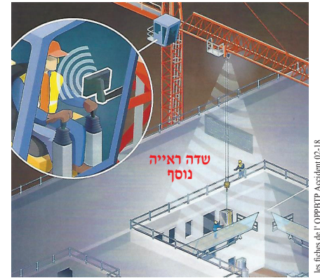
המצלמה המורכבת על העגלה שנועה לאורך הזרוע, מאפשרת את ראיית המטען גם בחלק המסלול שנסתר מעיני העגורנאי
