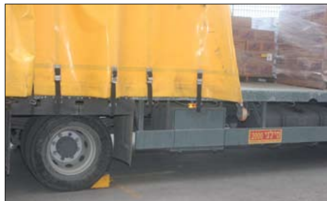
פריקה והעמסת משאיות במקום הייעודי והמסומן. ניתן לראות יישום נהלים - בולם לגלגלים. החשוב מכל: הפקדת מפתחות הרכב בידי המלגזן בעת פריקה או טעינה
