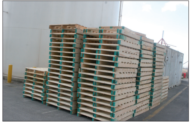
אחסון מישטחים. שיטת האחסון נותנת מענה נאות לדרישות שירותי הכבאות כך ש"מיטען האש" מרוחק משטח המבנה
