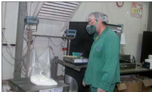
עמדת שקילת חומר גלם. העובד מצויד במשקפי מגן, בנשימת להגנת הנשימה בהפעלת מפוח יניקת אבק, ולראשו רשת להגנה מפני נשירת שערות לחומר הגלם
