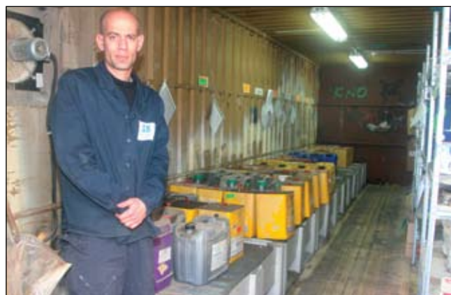
שחר ונד במחסן הטכני של חומ"ס הממוקם במכולה. המכולה אמורה לתת מענה לריכוז כל החומרים הדליקים המוגדרים כחומרים מסוכנים. המכולה נעולה, נקייה ומסודרת. כל החומרים מונחים על גבי מאצרות. ליד כל חומר מוצמד גליון בטיחות. כל הציוד החשמלי מוגן התפוצצות
