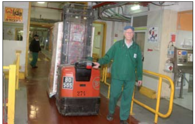
אולם ייצור. כלי מסוג "מפעיל הולך". לכל כלי יש מפעיל מורשה שהודרך והוסמך ונושא רישיון רכב בכלי בתוקף. ההפעלה אישית – בעזרת מפתח שנמסר לעובד המורשה במטרה למנוע הפעלה של ציוד באופן אקראי ע"י עובד אחר
