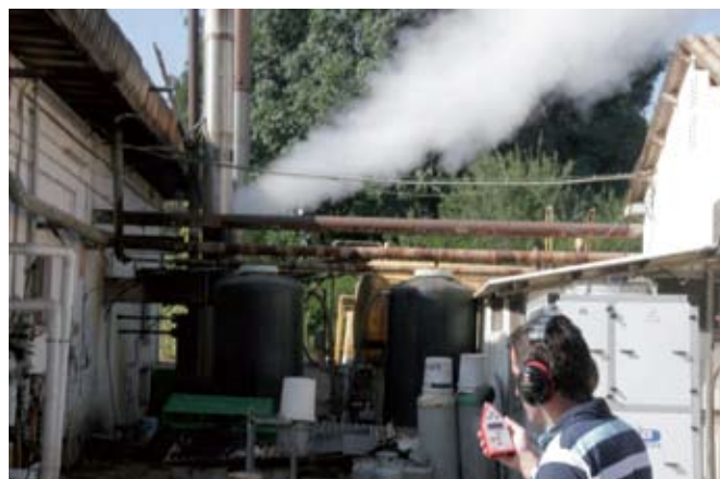
מדידת עוצמת הרעש בעת פריקת שסתום הבטיחות במרחק של כ-15 מ' ממקור הרעש
