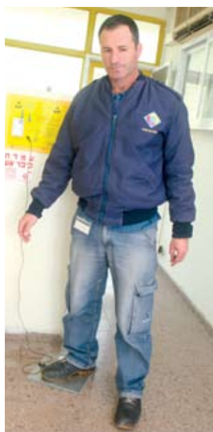
יוסי קיטסקי, ממונה בטיחות של מיתקני הצפון בתש"ן, מדגים בדיקה אנטי סטטית לנעלי בטיחות
