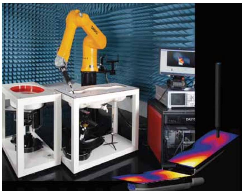
איור 3: מערך למדידות שיעור הספיגה הסגולית (SAR) הנוצר בפעולת טלפון סלולרי (מתוך אתר חברת Speag, www.speag.com )
