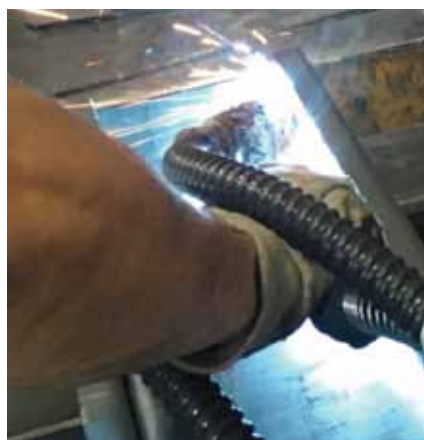
עשן הריתוך נשאב אל תוך הפייה ונלכד בתוך מערכת היניקה דרך הצינור הגמיש
