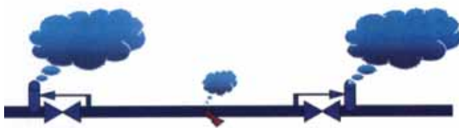
תרחיש סיכון: שחרור מהיר של גז אל מחוץ למערכת, כגון דליפה בצינור או שחרור משסתום ביטחון
