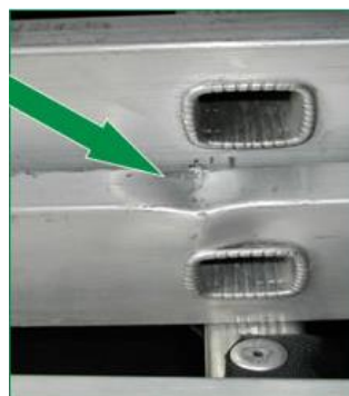
איור מס' 4 פגיעה בזקיף הסולם
