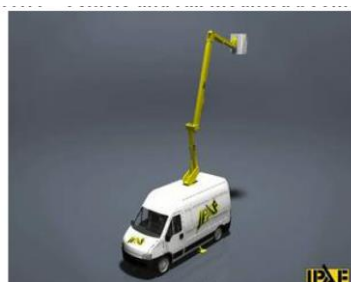
במת מותקנת על רכב (מקור מס' 8 ברשימת המקורות)
