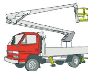
במת מותקנת על רכב (מקור מס' 8 ברשימת המקורות)
